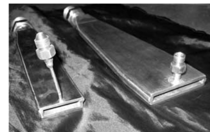
Рис.6.10 Формы плоских сопел для формирования сверхзвуковых гетерогенных потоков
