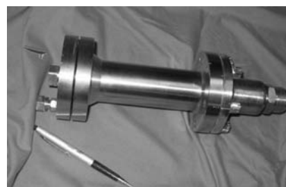
Рис.6.26. Сопло продольное для формирования покрытий на внутренние поверхности каналов: габаритный диаметр 90 мм, размер щели на выходе из сопла 2,5 мм [144]
