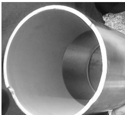
Рис.6.28. Покрытие из цинка на внутренней поверхности стальной трубы
