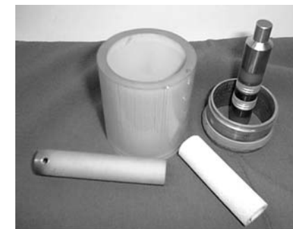
Рис.6.31. Покрытия из алюминия, никеля, цинка, тантала и Al_2O_3 на разных металлических и неметаллических поверхностях внешних и внутренних
