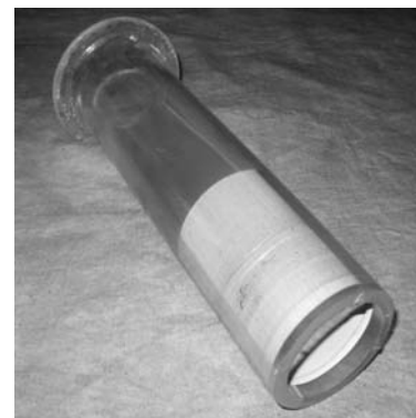
Рис.6.30. Покрытие из алюминия (порошок АСД-1) на внутренней поверхности стеклянной трубы
