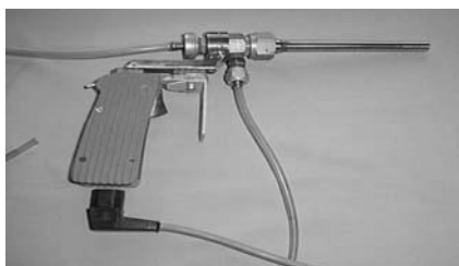
Рис.6.17. Ускоритель пистолетного типа с коническим ускорителем мобильного стенда для работы в полевых или иных условиях [143]
