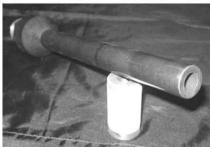
Рис.6.15. Конический ускоритель для формирования сверхзвуковых гетерогенных потоков
