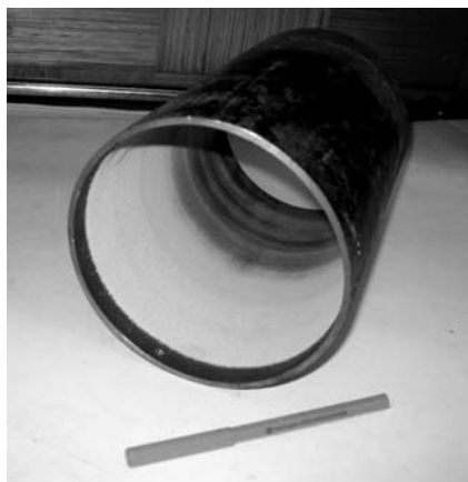
Рис.6.29. Покрытие из алюминия на внутренней поверхности стальной трубы
