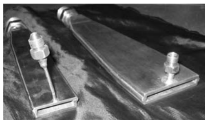
Рис.6.16. Плоский ускоритель для формирования сверхзвуковых гетерогенных потоков
