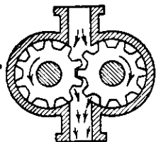
Фиг. 153. Схема шестеренчатого насоса.
