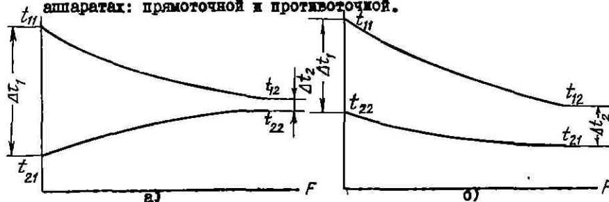
Рис. 1. Распределение температур теплоносителей: в прямоточной (а) и противоточной (б) схемах
